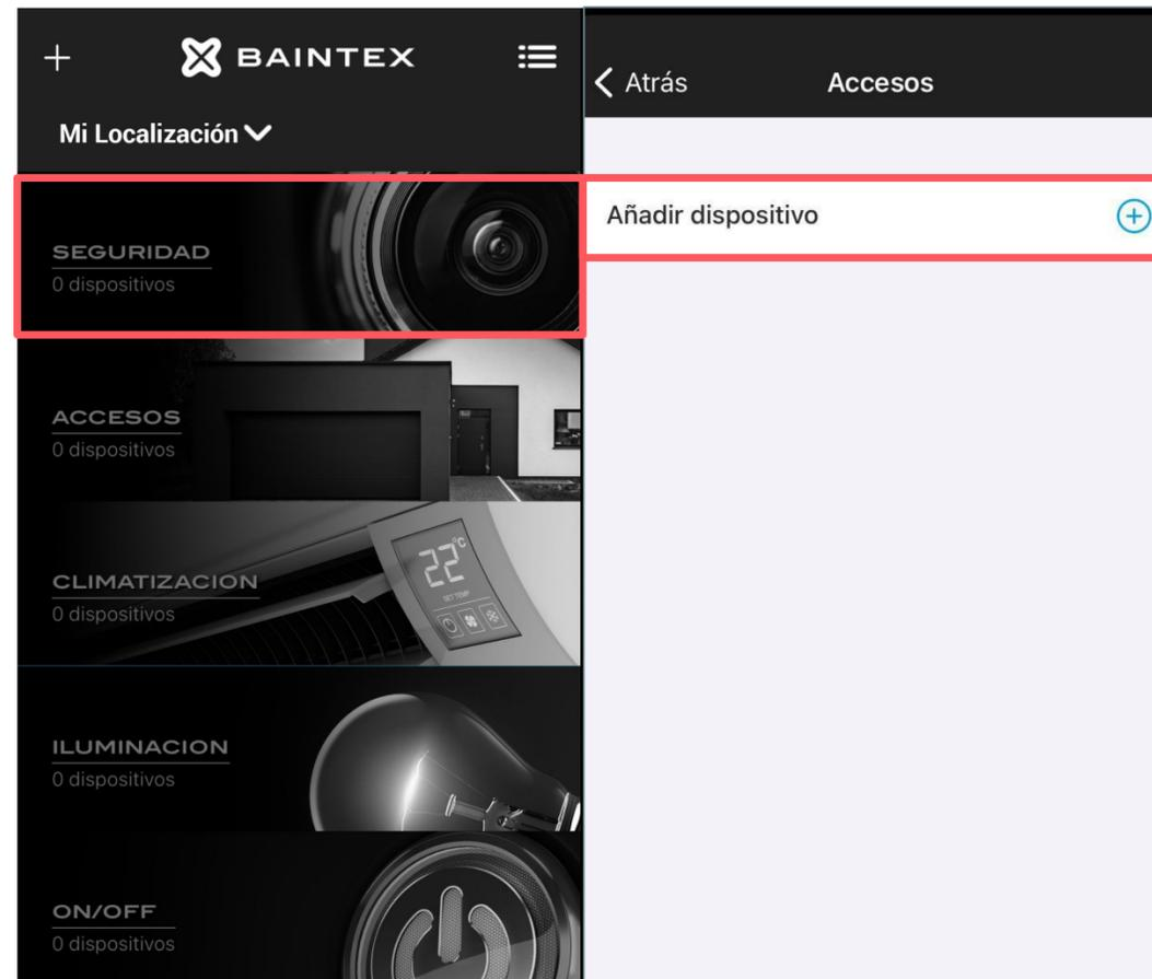
En la app Everou, haz click en "seguridad", pulsa en "añadir dispositivo" y mantén presionado el botón de enlace de la cámara durante 5 segundos para que se produzca la conexión entre ambos dispositivos
